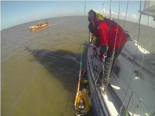
In vielen Fällen reicht die Länge des Netzes aus, um vom Handläufer über die Relling geworfen zu werden, so dass die Person, über die Relling geholt, gleich an Deck zu liegen kommt. Man kann sich so das Anschlagen an der Fussreling und das Entfernen des unteren Relingsdrahtes ersparen.
